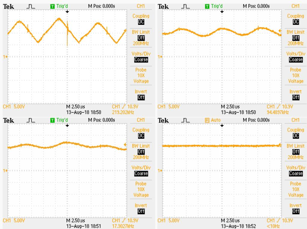
Erste Messungen wurden mit einer Gleichstromquelle durchgeführt, mit welcher der AD-Wandler gute und genaue Werte liefert. Mit der Durchführung von Messungen am Ausgang der Stabilisatorschaltung des Photomultipliers traten deutliche Abweichungen zu Messungen mit einem Multimeter auf, insbesondere ergaben sich zeitliche Schwankungen bei der Messung. Die Bildschirmausdrucke eines Oszilloskop zeigen deutliche Wechselstromanteile.
